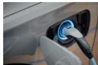
Demgegenüber ist die einfachste Variante des bidirektionalen Ladens bereits in einigen E-Auto Modellen anzutreffen: Mit einem Umrichter am äusseren Ladeanschluss können elektronische Geräte – vom Handy bis zum Akkuschauber – aufgeladen werden. Vehicle-to-Load (V2L) respektive Vehicle-to-Device (V2D) nennt sich diese Option.
