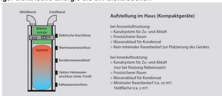
Wärmepumpen-Wassererwärmer sind äusserlich kaum von gängigen Elektroboilern zu unterscheiden. Sie bestehen aus einer Luft-Wasser-Wärmepumpe und einem Warmwasserspeicher.
